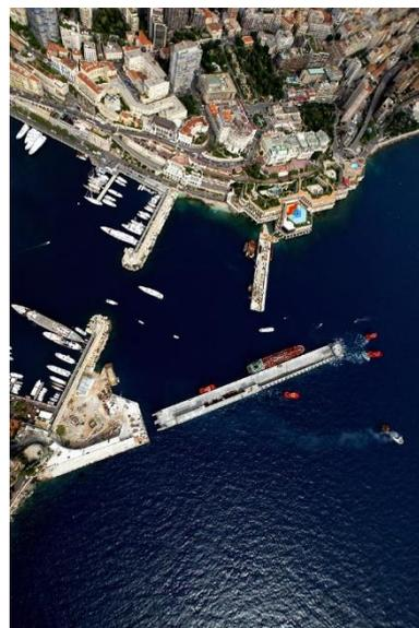
*Digue à la fin de la manœuvre de mise en place avant l'installation*
